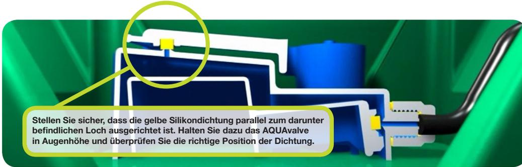
Stellen Sie sicher, dass die gelbe Silikondichtung parallel zum darunter befindlichen Loch ausgerichtet ist. Halten Sie dazu das AQUAvalve in Augenhöhe und überprüfen Sie die richtige Position der Dichtung.
